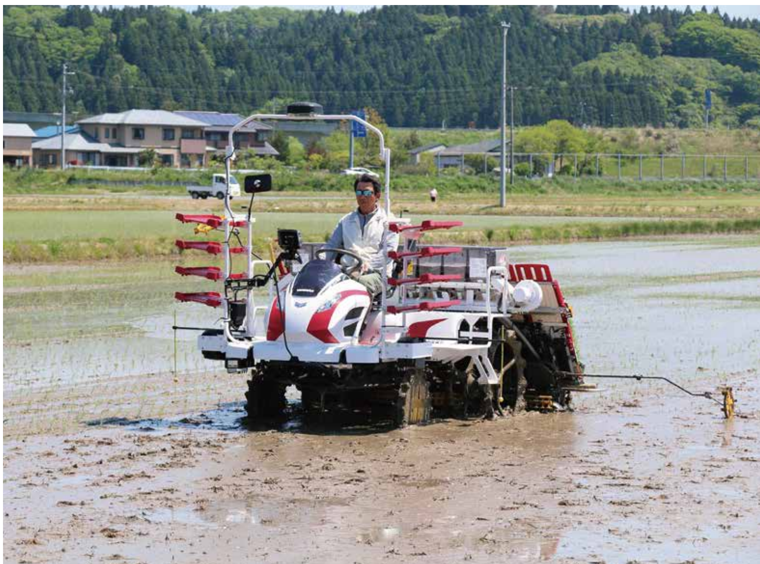
AIを活用した田植え同時可変施肥の実証試験(秋田市河辺)
